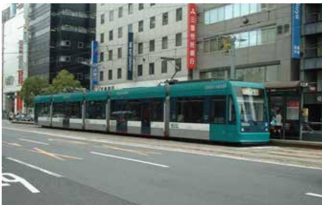
広島電鉄のGREEN MOVER。全長約30m。「LRT県市案」は輸送力確保のため36m級の車両を想定している。
