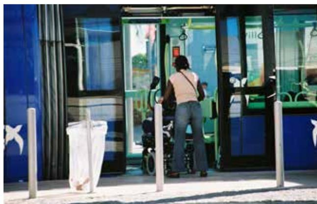
LRTの車両は電停との間に段差も隙間もなく、扉は広い。窓が大きく、街を近く感じる。(フランス・モンペリエ)
