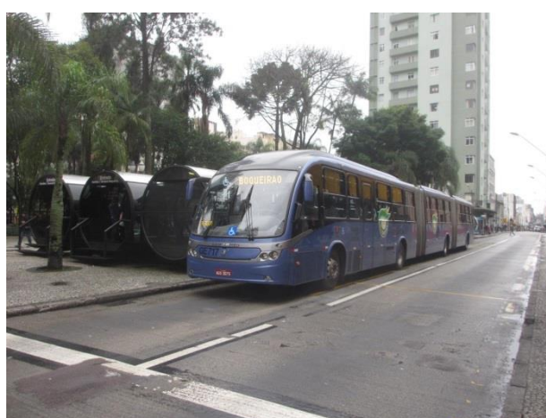
写真2：BRT クリチバ（ブラジル） 3車体連接で定員150人、左に見えるチューブ式のバス 停に入る際に料金前払いで入り、乗降時間が短縮 専用走行路を走り、バス沿線のみ開発が許可される
