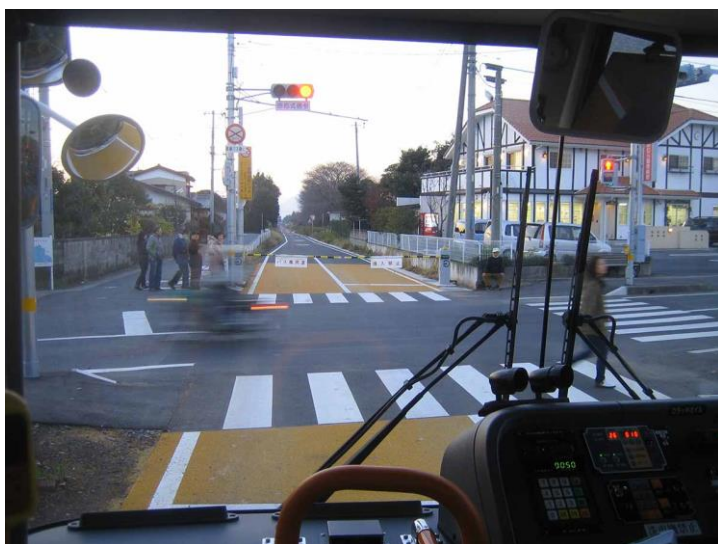
写真 4 : 日本版 BRT BRT と称し、鉄道廃線跡の専用走行路を走るが、一般道路との交差部ではバスのほうが遮断機で待たされる。廃線跡の再整備に 6.5 億円かけたが、利用者は鉄道時代の 35% に減少
