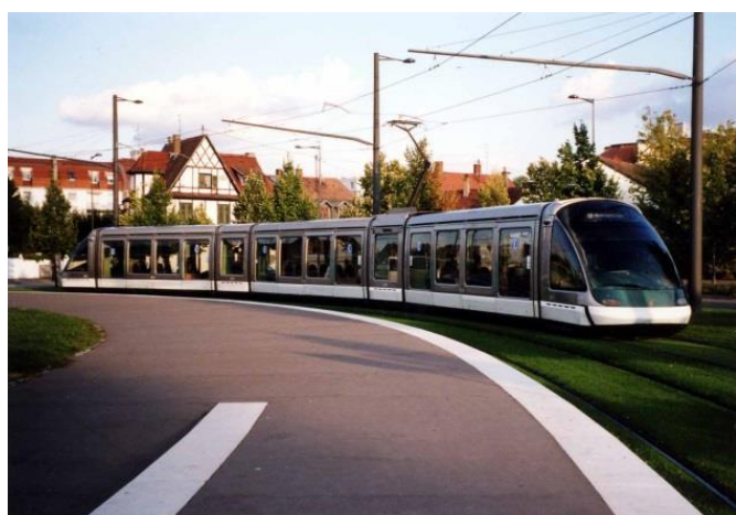
写真1：LRT ストラスブール（フランス） 7車体連接で定員200人（4両分に相当） これを2編成連結して定員400人とした電車も走る フィーダーバスやP&Rも同時に整備される
