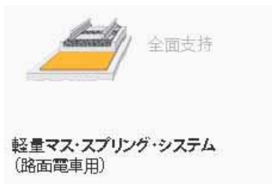
図3：耐振・防音マット 軌道敷の下に敷くだけで振動や騒音を軽減できる絶縁体のマット（ゲッツナーHPより）
