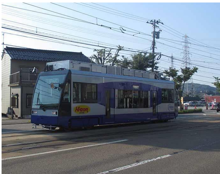
写真6：バッテリートラム 高岡 バッテリートラムの社会実験実施。パンタグラフを降ろして、バッテリーのみで走行中
